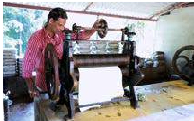
Pressen der Gummiplatten
